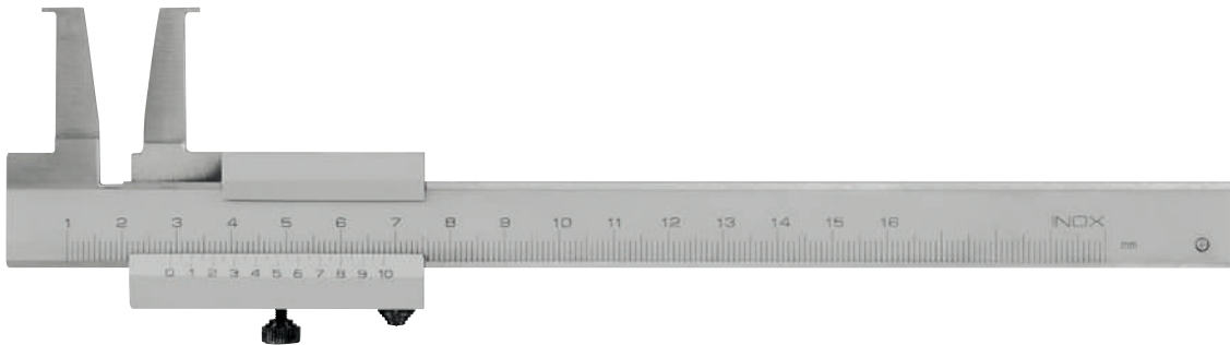
Calibro per gole interne Nonio 1/20. Lettura 0,05 mm. Corsoio con vite di bloccaggio. Scala cromata opaca.
