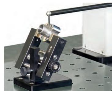
Le guide a innesto, l'ampia gamma di dispositivi di serraggio standardizzati e i relativi supporti permettono il posizionamento flessibile del pezzo.
