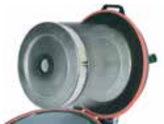
Filtro anti-nebbia (optional), evita che particelle di olio e acqua si trasformino in vapore
